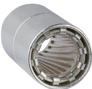
RADSO<sup>K</sup>®（ラドソック）とは、アンフェノールが特許を取得している、ソケットコンタクトの技術です。双曲線形状の格子に多くの接触点を発生させることで、通常コンタクトの1.5倍の大電流を流すことができます。
