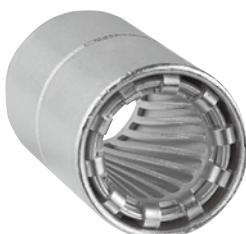
RADSOK®（ラドソック）は、双曲線形状の格子に多くの接触点を発生させて大電流を流すことが出来るソケットコンタクトの技術です。接触面積を増大させながら、嵌合するピン全体に均等の弾性圧力を加えることで、驚くほど柔らかな挿入感と高い耐久性を実現します。
