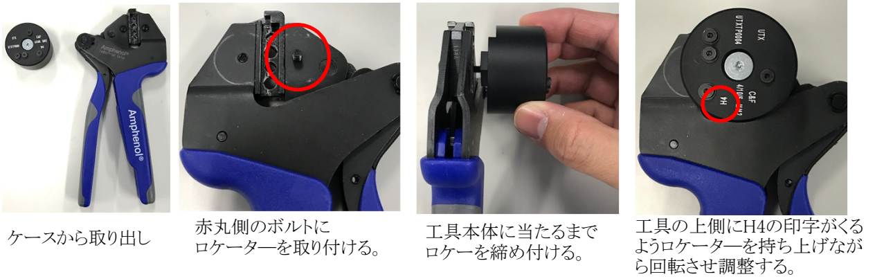
図-6: ロケータ取付け
