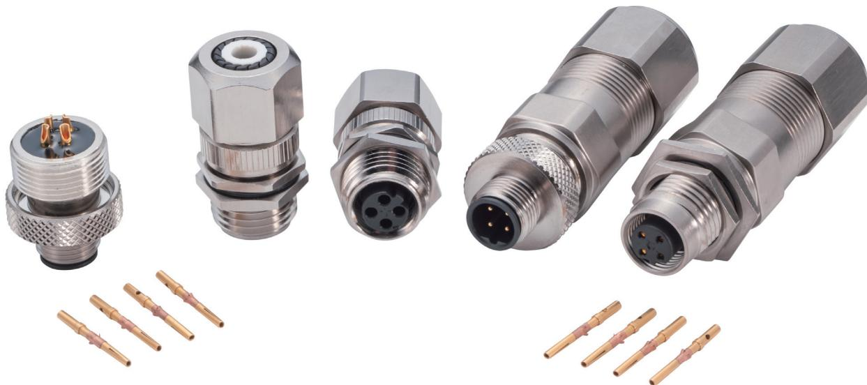
高振動、高温などの苛酷な条件をクリアする、高速データリンク接続用M12コネクタです。IEC61076-2-101およびJ2839規格に準拠して開発されており、建機、農機、鉱業機械、鉄道車両、ファクトリーオートメーションなどの非常に厳しい環境で使用できます。EtherCAT対応ケーブルアセンブリも提供可能です。
