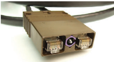
コンポジットシェル、OD色カドミウムめっき、RJ45イーサネット用インサートx2 組込み
