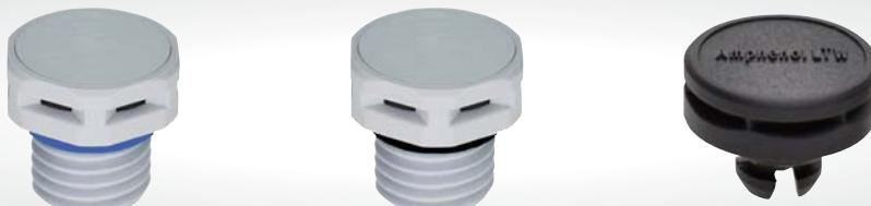
VEシリーズは、多孔質ポリテトラフルオロエチレン (ePTFE) メンブレンを採用した防水通気フィルタです。急速な温度変化や気圧変動により生じる密閉筐体内の結露や湿気を、自動的に圧力調整することで、腐食や劣化を加速させる液体や汚染物が内部の電子機器に侵入するのを遮断します。
