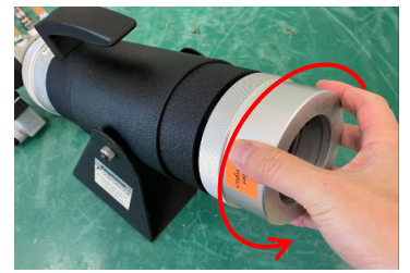
(b) カバーナット取り外し
