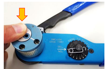
(g) タレットヘッド押し込み
